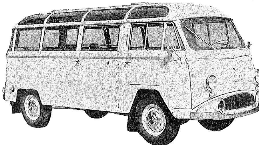
**Otto-Motor · 4 Zylinder · 4-Takt · 48 PS, bei 4100 U/min****Sitzplätze: 12 + 1****Triebwerk****Motor**
